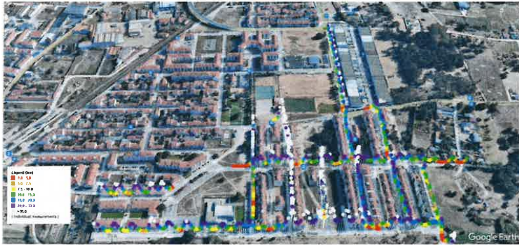
Figura 18 – Análise à iluminação na Vila Verde, Alhos Vedros, Moita
