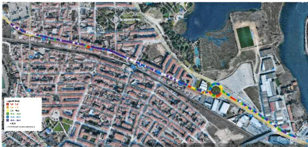
Figura 19 – Análise à iluminação na Estrada Nacional, Baixa da Banheira, Moita
