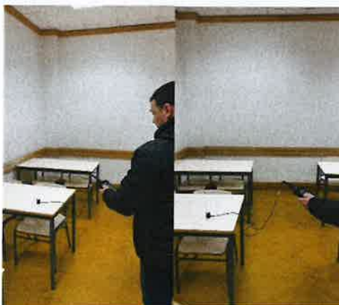
Figura 32 – Medição de níveis de iluminação no plano de trabalho, numa sala de aula de uma escola intervencionada
