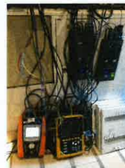
Figura 3 – Equipamentos que permitem a disponibilidade para a ação 3.1 (primeiras duas fotografias) para análise das condições de utilização dos edifícios e eficiência de utilização (condições térmicas e ambientais), além de equipamentos de medição dos consumos de energia elétrica (analísadores de energia)
